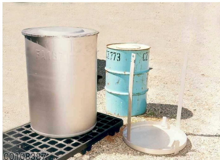
Figure 3-5 Fût de déchet bitumés du site du CEA de Marcoule (en bleu à droite) et le sur-fût EIP (à gauche) (source Inventaire national Andra)
