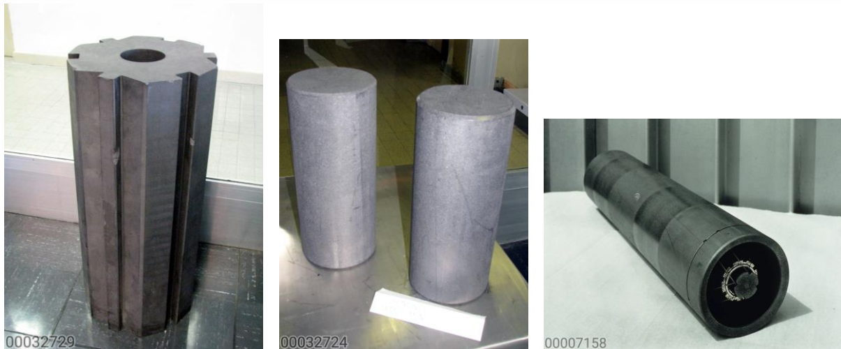
Figure 3-4 Brique de l'empilement du réacteur EDF de Bugey 1 (gauche), rondins de la protection biologique du réacteur de Bugey 1 (milieu) et chemise des réacteurs EDF de Saint Laurent (droite) (source illustrations EDF)
