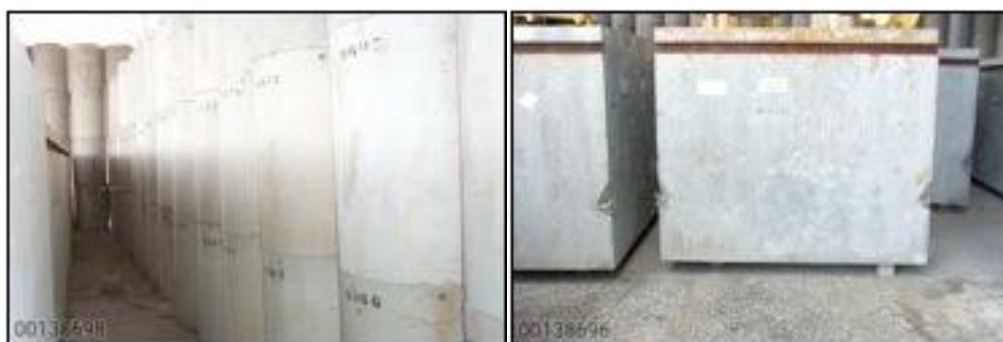
Figure 3-3 Colis de déchets dits « sulfate de plomb radifères » entreposés sur le site du CEA de Cadarache (source illustrations - Inventaire national Andra)
