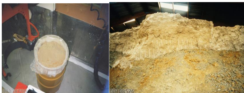
Figure 3-1 Déchets radifères entreposés sur le site de Solvay de La Rochelle – Résidus radifères RRA (à gauche) et Résidus solides banalisés RSB (à droite)
