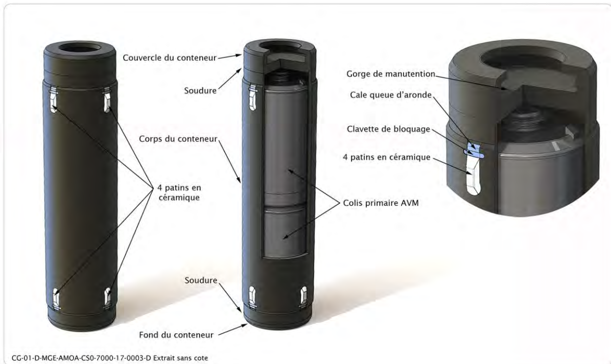
Figure 2-7 Schéma de principe d'un colis de stockage HA
