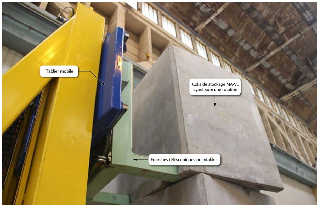
Figure 2-25 Test de récupération d'un colis MA-VL désaxé sur sa pile
