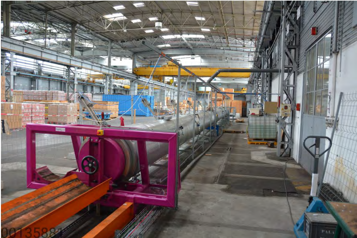
Figure 2-27 Banc d'essais de récupérabilité des colis HA (alvéole en température, avec vapeur d'eau condensée)
