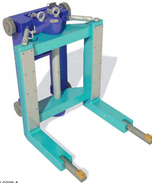
Figure 2-17 Illustration du système à fourches télescopiques orientables pour repositionnement ou reprise des colis MA-VL
