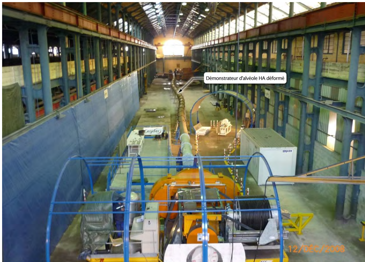
Figure 2-26 Test de mise en place et de récupérabilité sur 100 mètres de longueur d'un colis HA dans un alvéole fortement déformé, à l'aide du « robot ESDRED »
